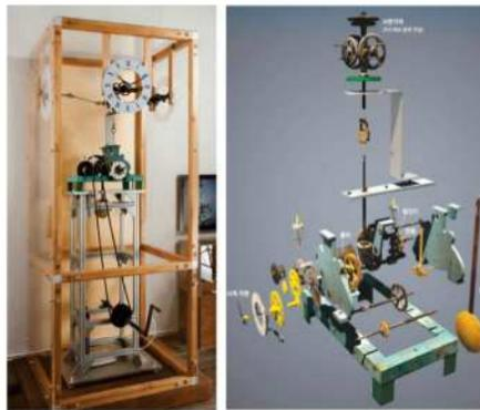
원래 동서남쪽 세 방향에 있고 모(母)시계의 톱니바퀴가 3개의 자(子)시계 톱니바퀴에 비스듬하게 연결되어 돌아갔다. 바깥 벽면에 설치된 자 시계판의 지름은 125cm이고 시침과 분침이 1-2kg으로 무거워 반대쪽에 납덩이로 밸런스를 맞추어 쉽게 돌아가도록 하였다.
